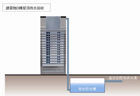
f. 建築物 D 棟屋頂雨水貯集系統
