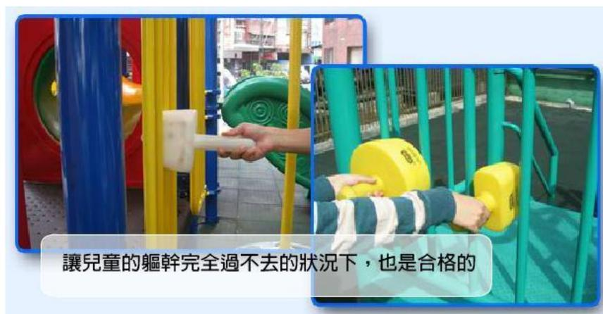
頭部誘陷：軀幹探測器可以通過完全侷限開口(洞)，但頭部卻無法通過，造成頭部誘陷。圖片如下：
