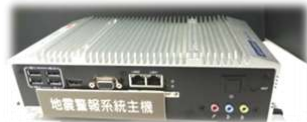
地震警報系統主機正面照
