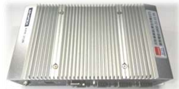
地震警報系統主機俯視照
