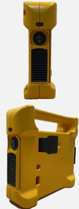
監控裝置每30秒會傳送一次訊號到平台，運送過程中可以透過平台確認運輸路線和溫度
